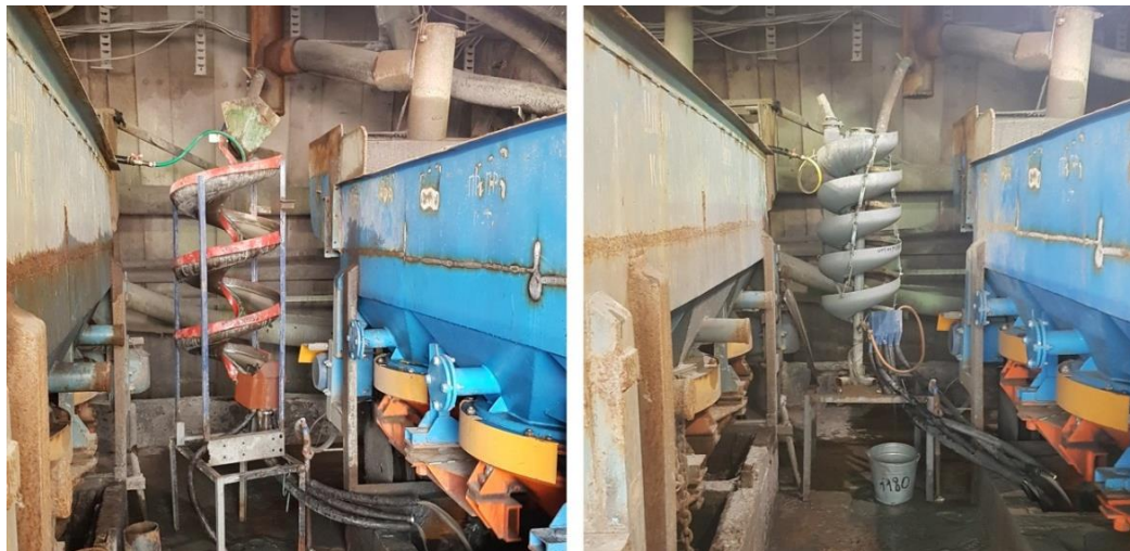
Рисунок 4.5 - Винтовой шлюз ШВ-500 (а) и винтовой сепаратор ВСП-500 (б), установленные на участке основной отсадки обогатительной фабрики.
